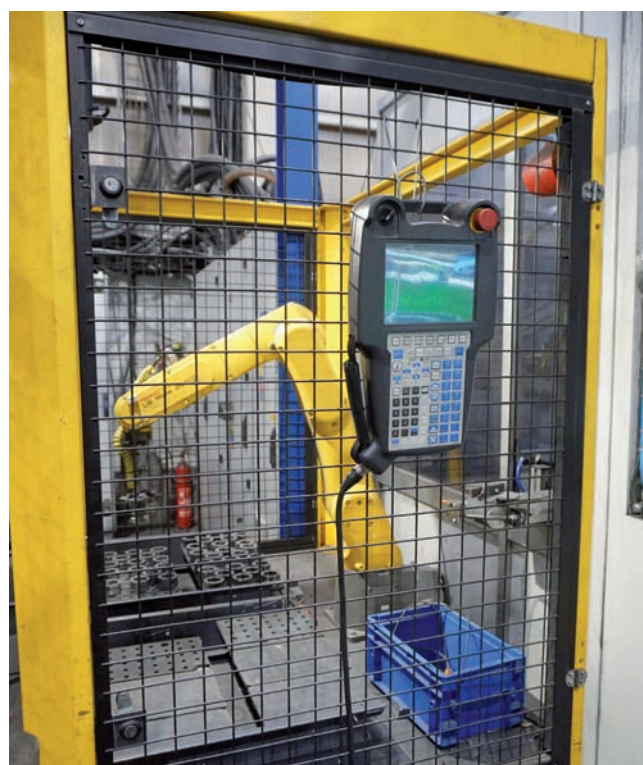
Vzhľadom na to, že výlisky sú pomerne krehké, treba pri ich odoberaní robotom zvoliť primeraný spôsob uchopenia, ako aj uchopovacia silu.
