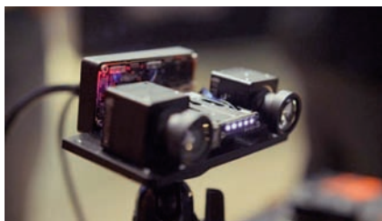
RGB-D kamera firmy XIMEA, na ktorej autor realizoval diplomovú prácu.
